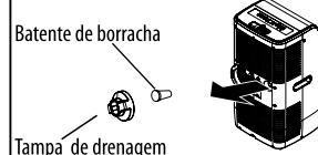
4. Passe o tubo de drenagem através da tampa de drenagem.
