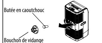
4. Faites passer le flexible de vidange à travers le bouchon de vidange.
