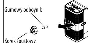
4. Przełożyć wąż spustowy przez korek spustowy.
