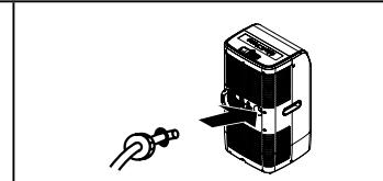
Il dispositivo di arresto e un esamento che serve a impedire che il tubo rientri eccessivamente nell'apparecchio.
